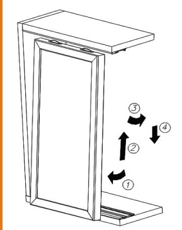
Установку дверей удобнее проводить двоим. Оба человека одновременно, взявшись двумя руками по длинной стороне дверного полотна, должны установить дверь в направляющие: погрузить верхние ролики вовнутрь верхней направляющей и установить нижние ролики на нижнюю направляющую. Аналогичную операцию произвести с внешней дверью и внешними направляющими.
